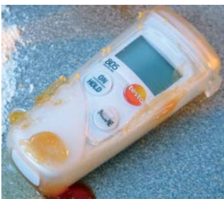
Wasserdicht und unverwundlich durch die Schutzhülle TopSafe
