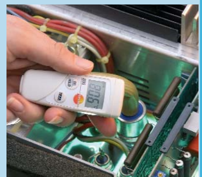
Schnell und zuverlässig heiße Bauteile finden
